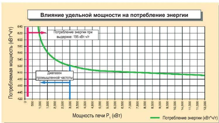
Рис. 16: Энергетическая диаграмма 12-тонной печи
