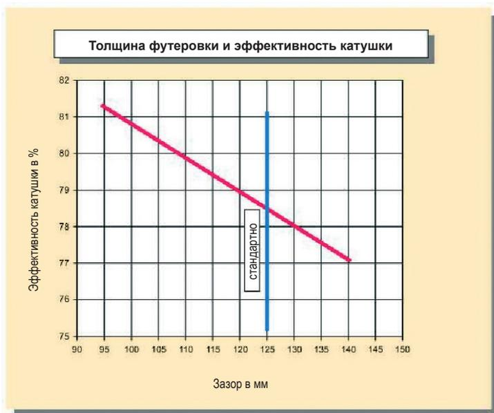
Рис. 19: Влияние толщины футеровки на эффективность катушки
