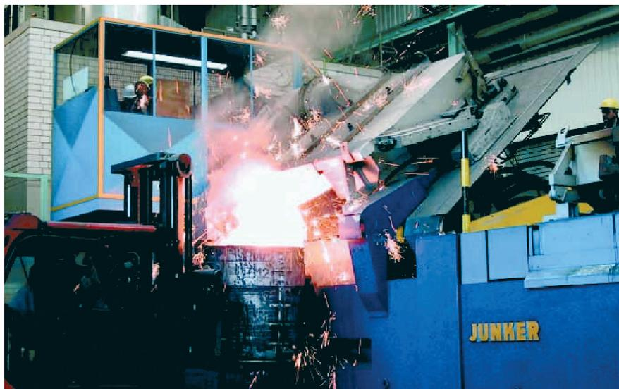
Рис. 21: Выпуск в ковш для транспортировки
