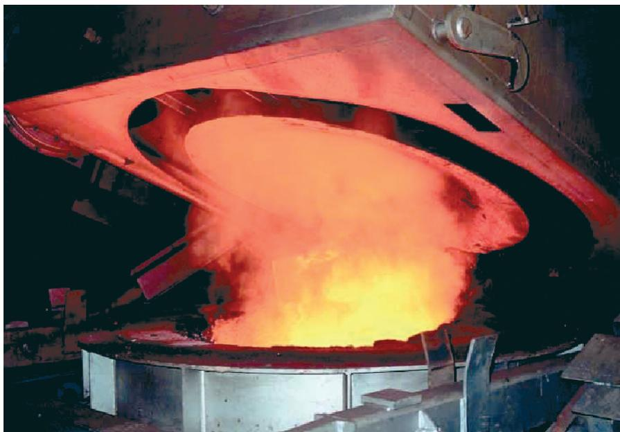
Рис. 32: Вытяжной колпак, встроенный в крышку печи
