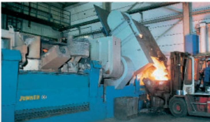
Рис. 8: Мощная среднечастотная плавильная установка – 12-тонная система DUOMELT номинальной мощностью 9000 кВт
