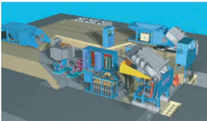
Рис. 2: Общий вид среднечастотной плавильной установки
