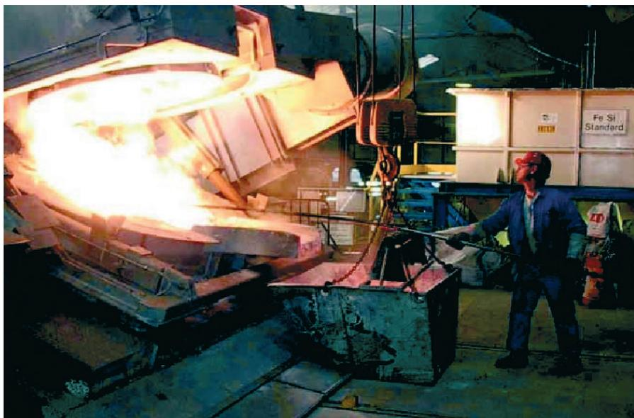
Рис. 30: Обратный наклон печи без сердечника
